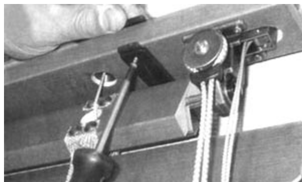
3 Positionner le store et fixer les vis
